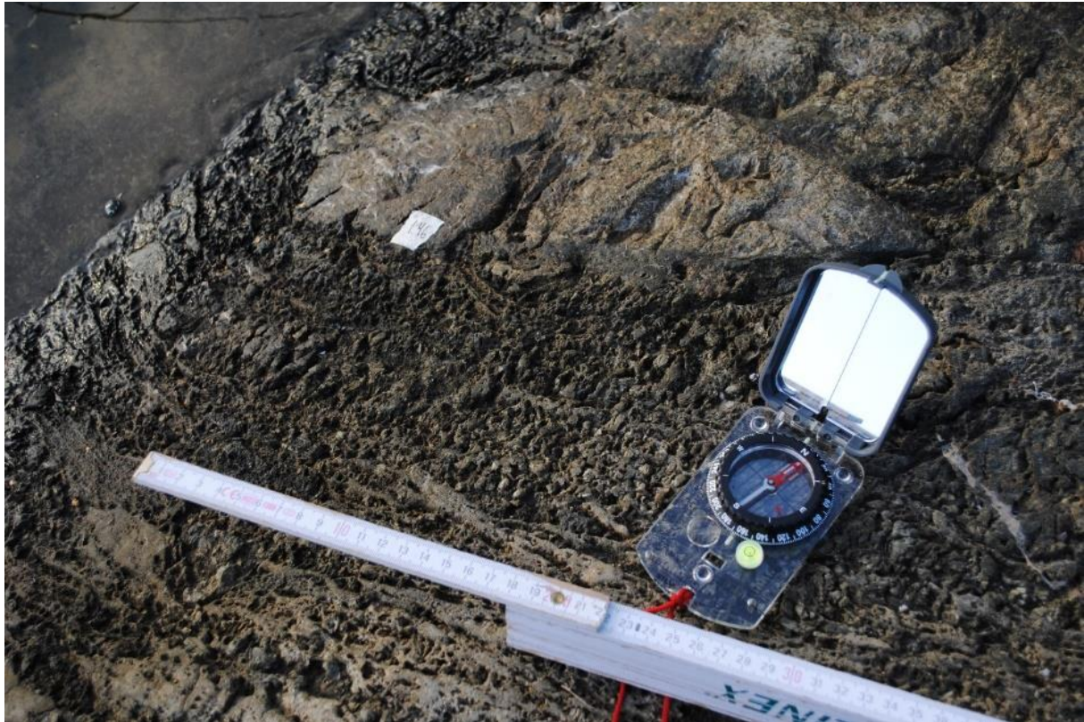
Figur 8. Vittring nära vattnet vid lokal 2 Mät punkt 1.46 är belägen 19,5 cm ö. h. Uppmätt relativ vittringskillnad ( d ) för mät punkten: 0,46 cm
