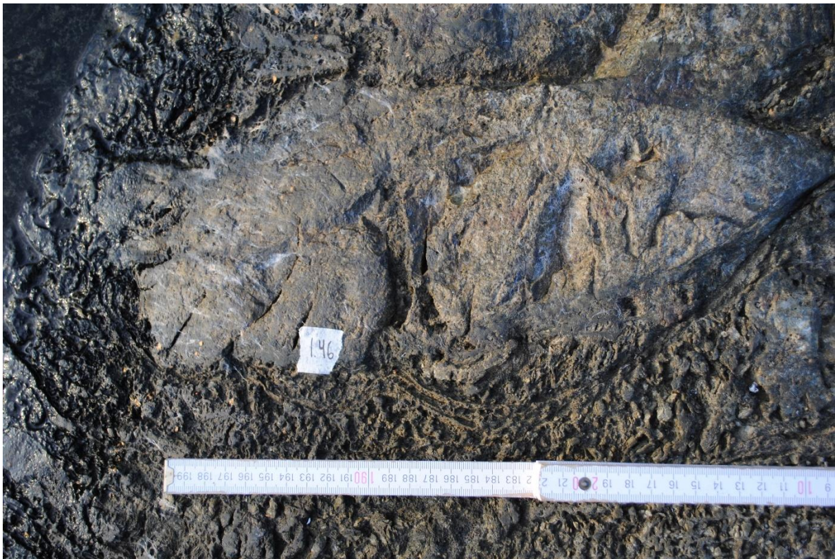
Figur 7. Vittring nära vattnet vid lokal 2 Mätunkt 1.46. Lokalen är belägen 19,5 cm ö. h. Uppmätt relativ vittringskillnad ( d ) för mätpunkten: 0,46 cm
