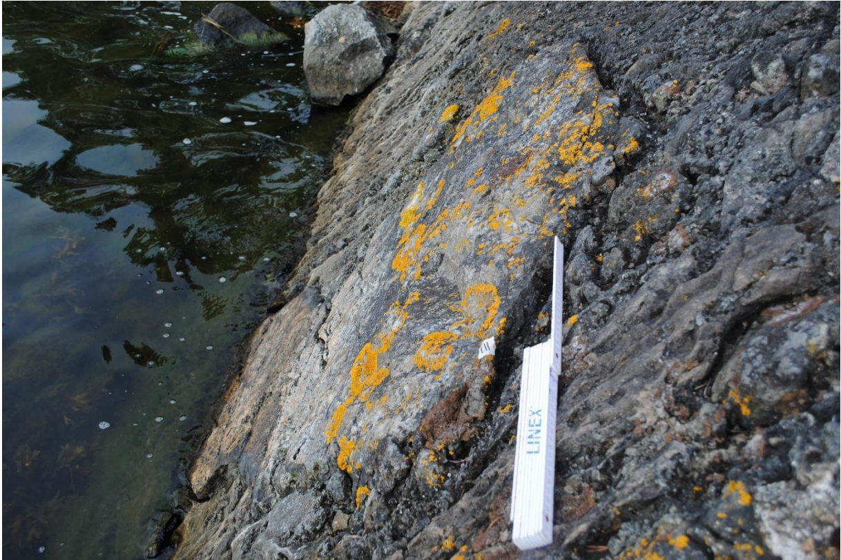
Figur 10. Vittring nära vattnet vid lokal 1, mätpunkt 1.11 Mätpunkten 1.11 är belägen 88,5 cm ö. h. Uppmätt relativ vittringsskillnad ( d ) för denna mätpunkt: 2,5 cm
