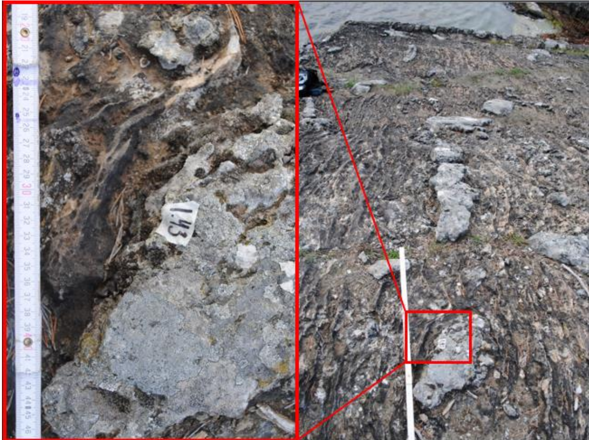
Figur 11. Vittring högre upp på hällen vid lokal 1 Till vänster är en närbild på mätpunkt 1.43 och den högra bilden är tagen längre ifrån. Mätpunkterna 1.43 & 1.431 är belägna 463,5 cm ö. h. Uppmätt relativ vittringsskillnad ( d ) för dessa mätpunkter: 2,7 cm & 2,5 cm
