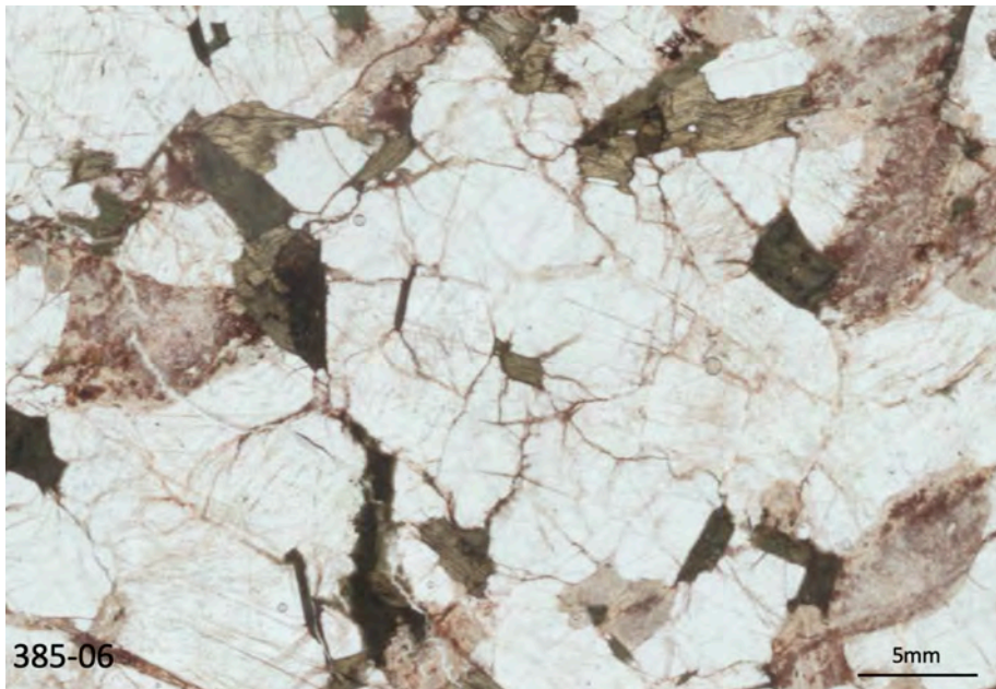
Figur 14. Visar ett flertal mörkt gröna (oxiderade) biotiter som spricker upp kvarts. Sprickor och sericitiserad plagioklas har röda fläckar.
