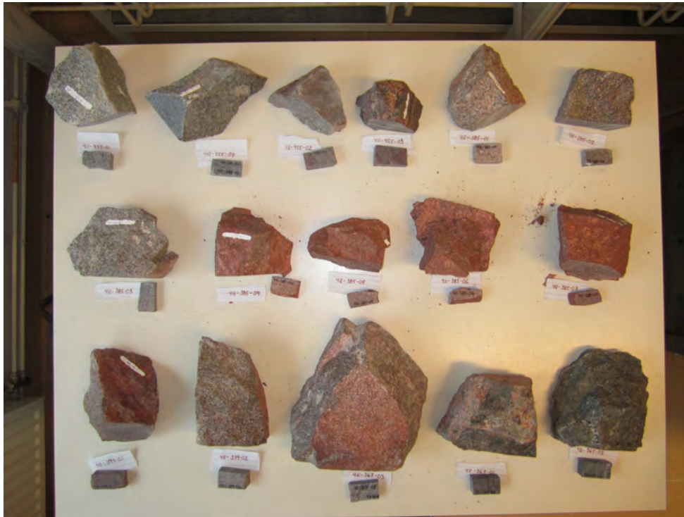
Figur 4. Stenprover med tillhörande tunnslipsblock. De är uppställda efter ordningen som de insamlades i tunneln, från sträcka km 0/455 i övre vänstra hörnet till km 0/367 i nedre högra hörnet.
