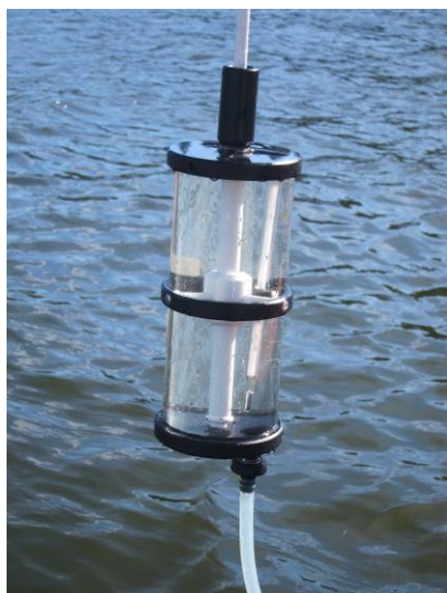
Figur 4. En Ruttnerhämtare kan användas för att hämta upp vattenprover från olika djup. Hämtaren stängs med hjälp av ett lod som löper utmed linan.
