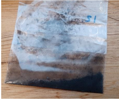
Bild 7 Exempel på batterimassa.
