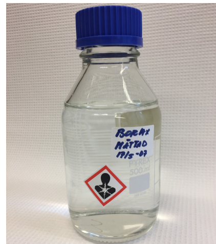
Märkning av mättad Borax-lösning Foto: KRC
