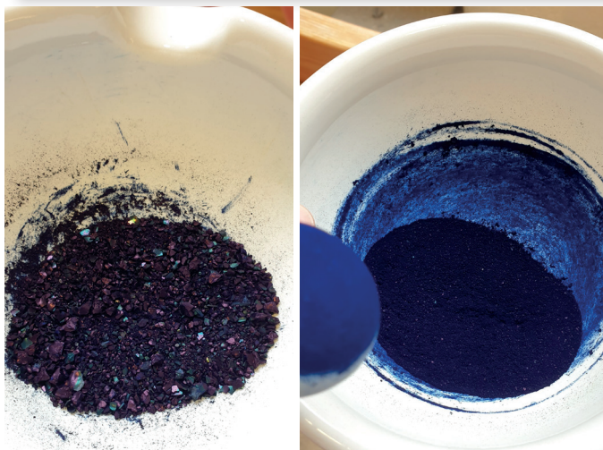
Berlinerblått före och efter mortling. Foto: Mohanad Al-Hayali
