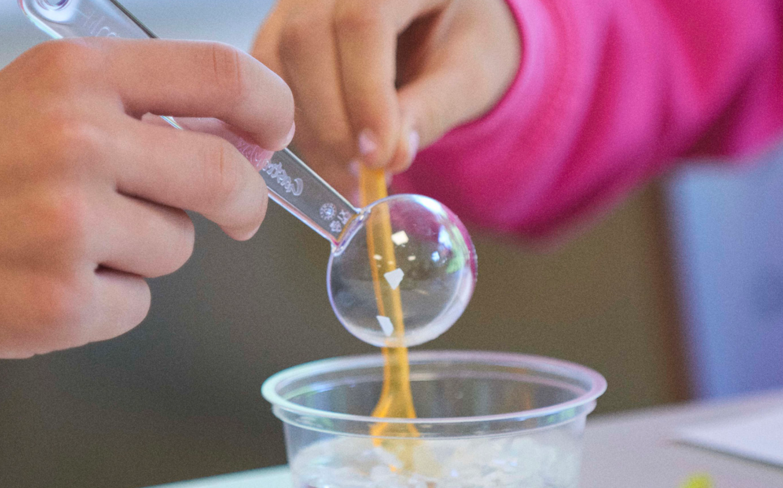
Koksalt höjer densiteten på vattenlösningen och plastbitarna flyter upp till ytan. Foto: IKEM
