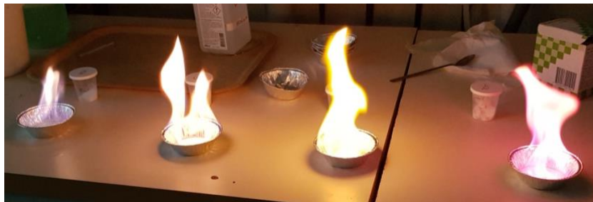
Bild 1: Lågfärger när etanol brinner med olika metallsalter. (Foto: KRC)
