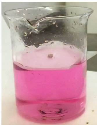
Bild 2: Försöket utförs i en bägare. Ett filterpapper med kalium flyter på ytan innan reaktionen startat. (Foto: KRC)
