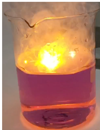
Bild 3: Vätagas som bildas i reaktionen antänds. (Foto: KRC)
