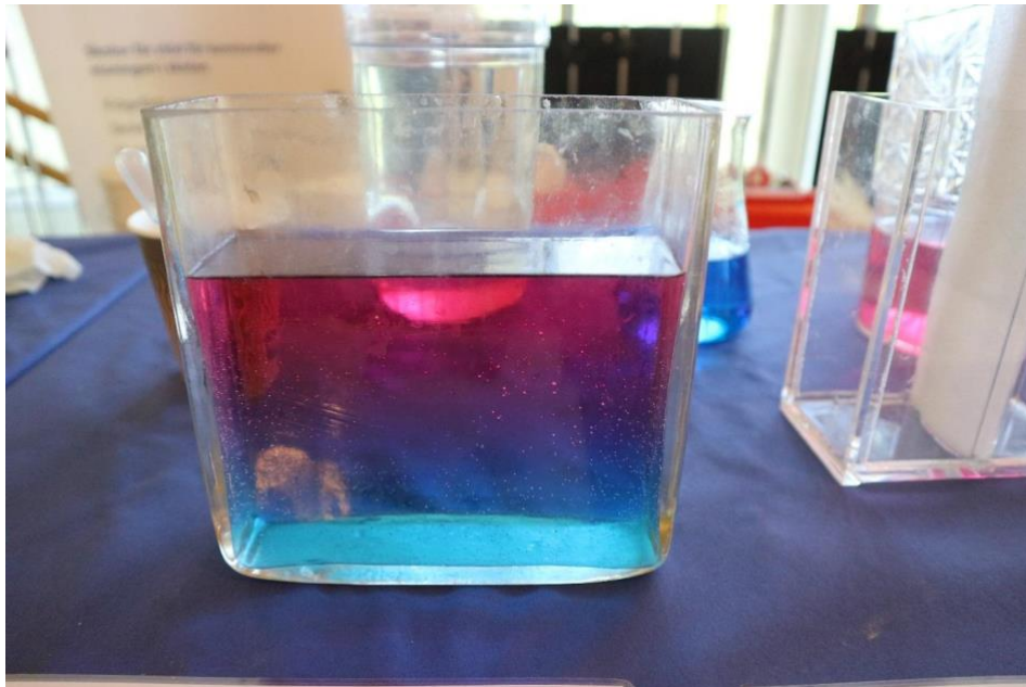
Bild 1: Till höger ses den experimentella uppställningen med en mellanvägg nedstucket i ett tomt kärl. I Kärlt närmast syns att vätskorna skiktat sig i ett rött och ett blått lager.
