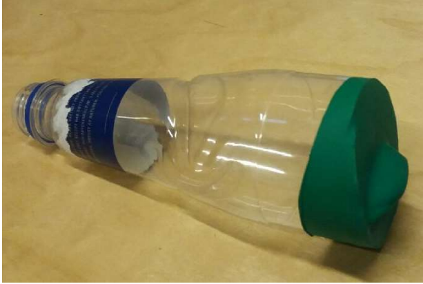
Figur 1 Luftkanon, som är tillverkad av en avskuren PET-flaska med en avklippt ballong fastsatt i botten.
