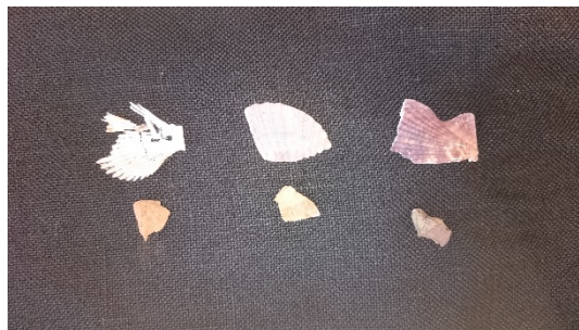
Foto på tre snäckskal och kalksten från experiment. Vänster pH 1, mitten pH 4, höger pH 7
