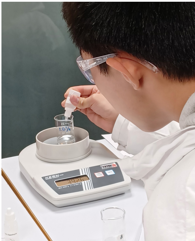
BILD 2: Gravimetrisk titrering ger elever vana att använda vågen som mätinstrument. (Foto: KRC)
